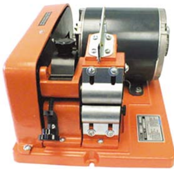
Настольная установка зачистки обмоточного провода с одной щеткой
