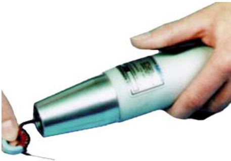
Ручное пневматическое устройство зачистки обмоточного провода
