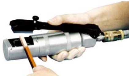
Ручное пневматическое устройство зачистки обмоточного провода с одной щеткой
