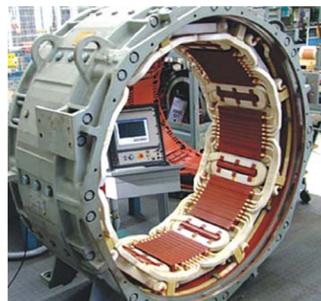
Статор тягового двигателя электровоза и тестер MTC2
